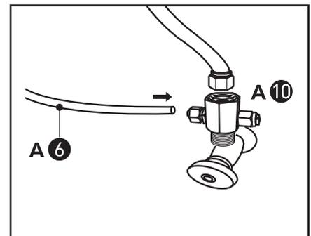
2. Verbinden Sie den Trinkwasser-Zulaufschlauch (A-6) mit der Schnellverschluss-Öffnung am T-Stück (A-10) und fixieren Sie den Sicherheitsstift 1/4" (C-6).
